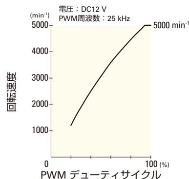
風量・静圧特性例 / PWMデューティ・回転速度特性例
