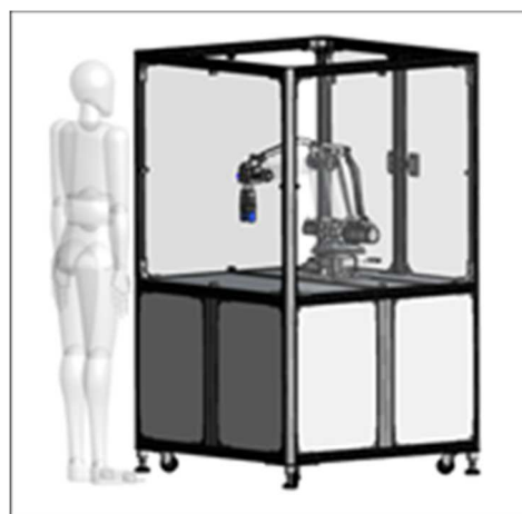
安全防護柵の例
