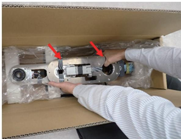
3. 設置場所に製品を置き、アームを固定しているバンドを外します。
