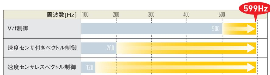
※輸出管理規定(周波数変換器)の見直しにより、出力周波数上限の599Hzを超えた場合は、インバータトリップします。
